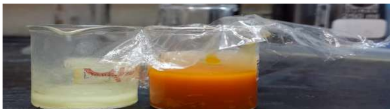
Figura 1. Proceso de blanqueamiento del aceite de palma mediante la utilización de la arcilla activada.
