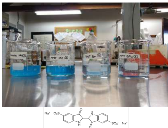
Figura 2. Resultados de adsorción del colorante índigo carmín mediante la arcilla modificada con Líquidos Iónicos.
