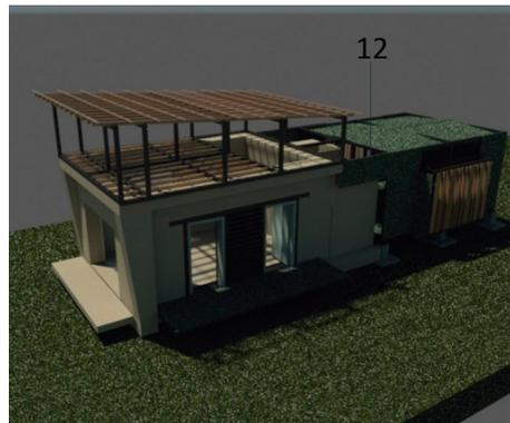
Figura 59h. Proceso 12: construcción de entramados de pisos en madera cargueras y alfardas. Se reparten las alfardas nivelándolas por encima, separadas a centro cada 50 cm (o 48 cm como ya se dijo); teniendo en cuenta la distancia a cubrir y clavándolas a la cerchas metálicas y cumbrera y al listón de apoyo. Las secciones de las alfardas varían de acuerdo con la distancia horizontal entre la cumbrera y el listón de apoyo.
