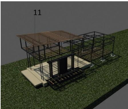
Figura 59f. Proceso 11: construcción de cerchas de cubierta y mezanines para luego proceder hacer vaciado del concreto en la corona de los muros.
