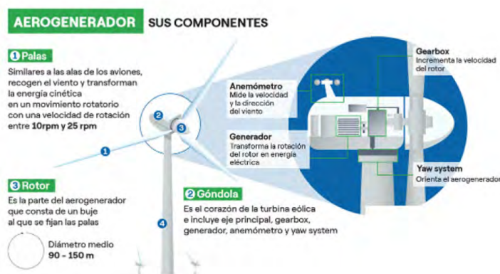
Figura 2. Componentes del Aerogenerador
